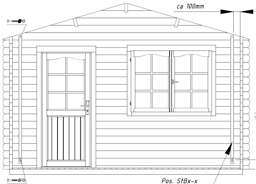
Installatie van de stormankers:
