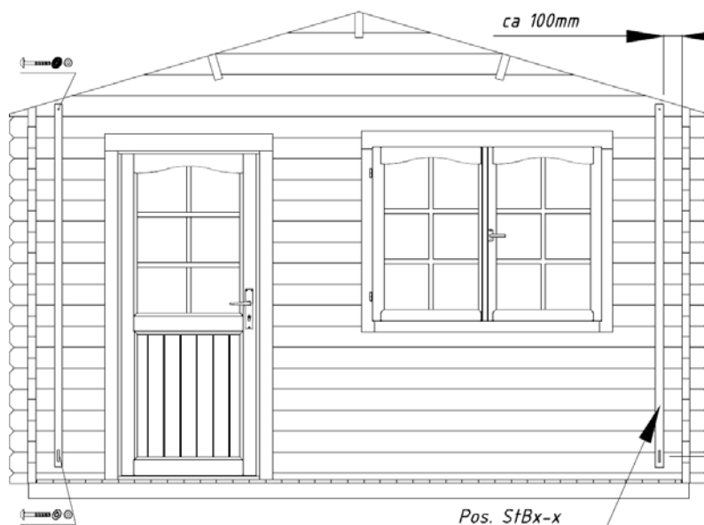
Montage des contreventements:
